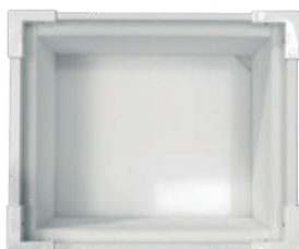
気泡状発泡 全面貼り
